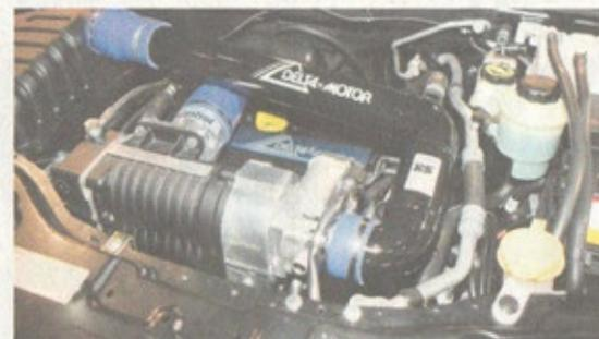
Mittels Lysholm-Schraubenkompressor wird die Leistung des 2,4-L im Opel Antara auf 200 PS angehoben.
